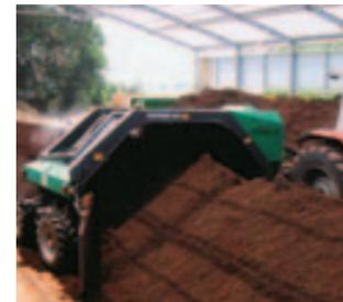
**前調整・破碎混合機 バイオチョッパーミキサー**
