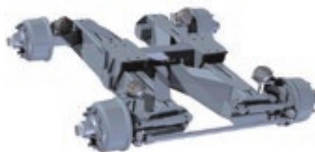
BAUERポリタンカーには、定評のあるBPW社製タンデムスイング車軸TDASLを採用。不整地においても、前後の荷重はセンターピットに集中し、左右のタイヤへ均等に分散させます。またワイドタイヤの低接地圧により草地へのダメージを最小に抑えます。
