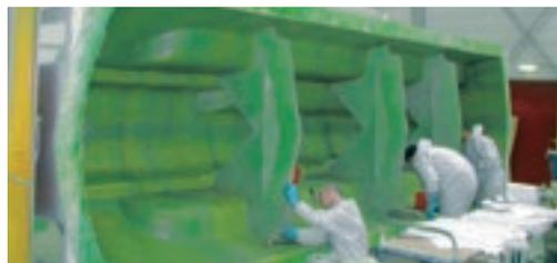
BAUERポリタンカーを特徴づける美しい緑のタンク。各部に必要なタンク厚を綿密に計算して1台ずつ丁寧に製作されています。フレームへの搭載部分は、より厚くラミネートし、強度の保持と全体重量の低減を図っています。いつまでも美しいボディ、BAUERがそのクラフトマンシップを生かしてお届けするBAUERスペシャリティの一品です。
