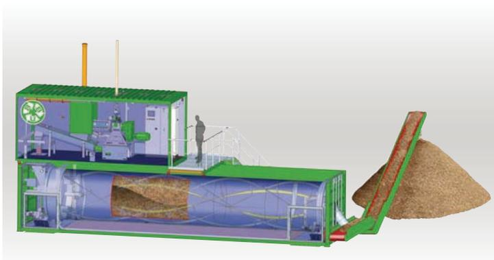
全自動・省力・スピーディーに戻し堆肥を製造するコンテナユニット。
