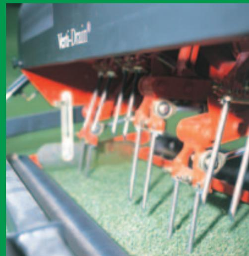
パラレル・リンク機構により、ターフ表面へのダメージは最小に抑えます。
