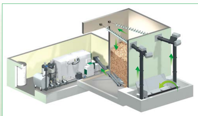
垂直投入システム (ダブル) とアジテーターシステムによる供給
