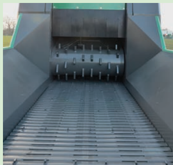
スムーズな供給を実現する開口部 幅1,200mm×高さ615mm
