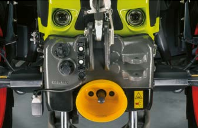
フロントリンケージには、スプールバルブ1系統と、フリーフローリターン(背圧なしの戻りライン)ラインが装着可能です。
