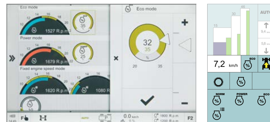
エンジン回転数メモリー作動時のエンジンドループ設定
