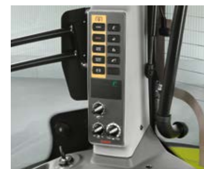
PTO回転速度と 電子リヤリンケージ機構 制御システムの調節は Bビラーで行う
