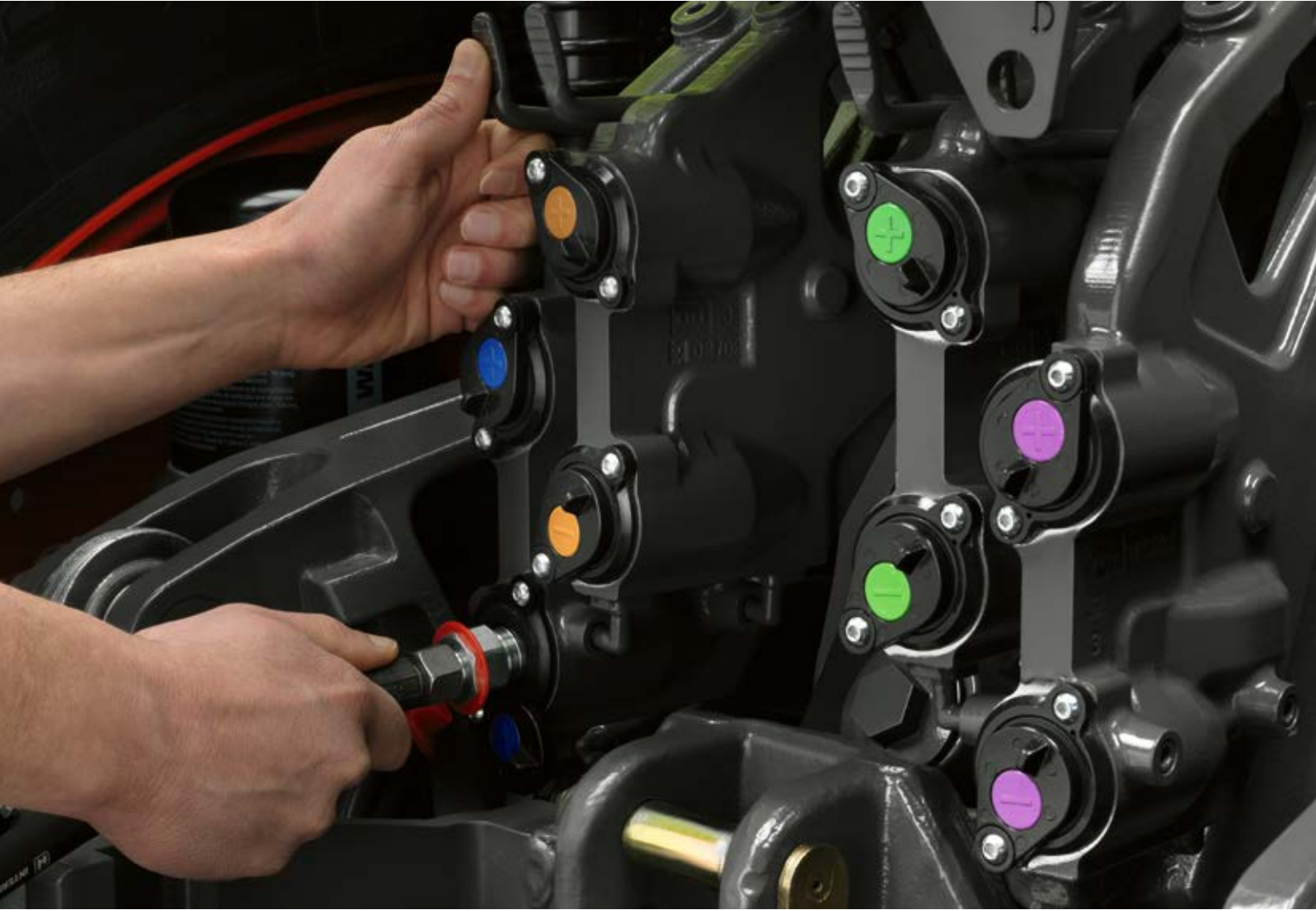
フロントリンケージには、スプールバルブ1系統と、フリーフローリターン(背圧なしの戻りライン)ラインが装着可能です。
