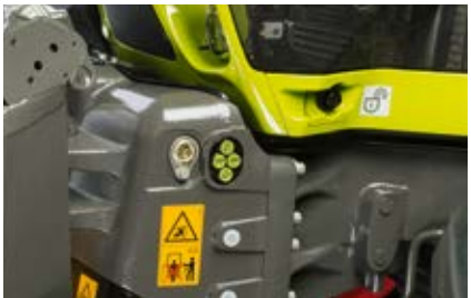
フロントリンケージとスプールバルブ用外部制御装置 (装備の場合)
