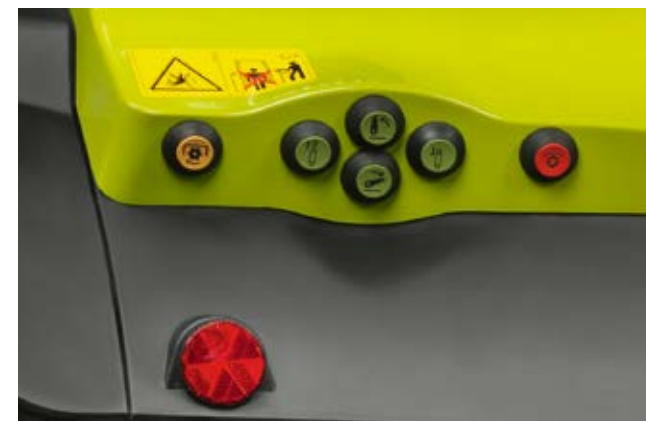
リヤPTOの外部コントロールボタン
