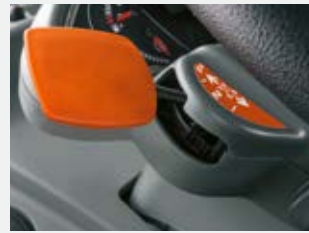
電動式パーキングブレーキが使用できる REVERSHIFTクラッチレスリバーサー
