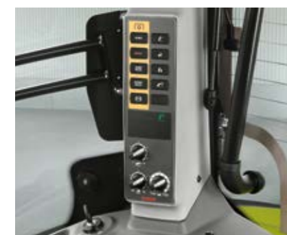
PTO回転速度と 電子リヤリンケージ機構 制御システムの調節は Bピラーで行う
