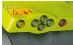
リヤリンケージ用外部コントロール。 PTO と一つのスプールバルブを 自由に選択できます。(CEBIS のみ)
