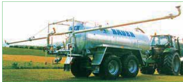
ダブルノズルスプレーブーム リアスプレッターを2つ装備することにより 注文時オプション (6,000 以上対象) 幅広い散布が可能 (最長 27m)
