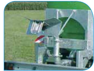
バッフルプレートスプレッター (PL-ER, PL-SF シリーズ共通標準装備)
