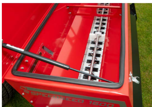
シードボックスは攪拌機構内蔵で詰まり無し
